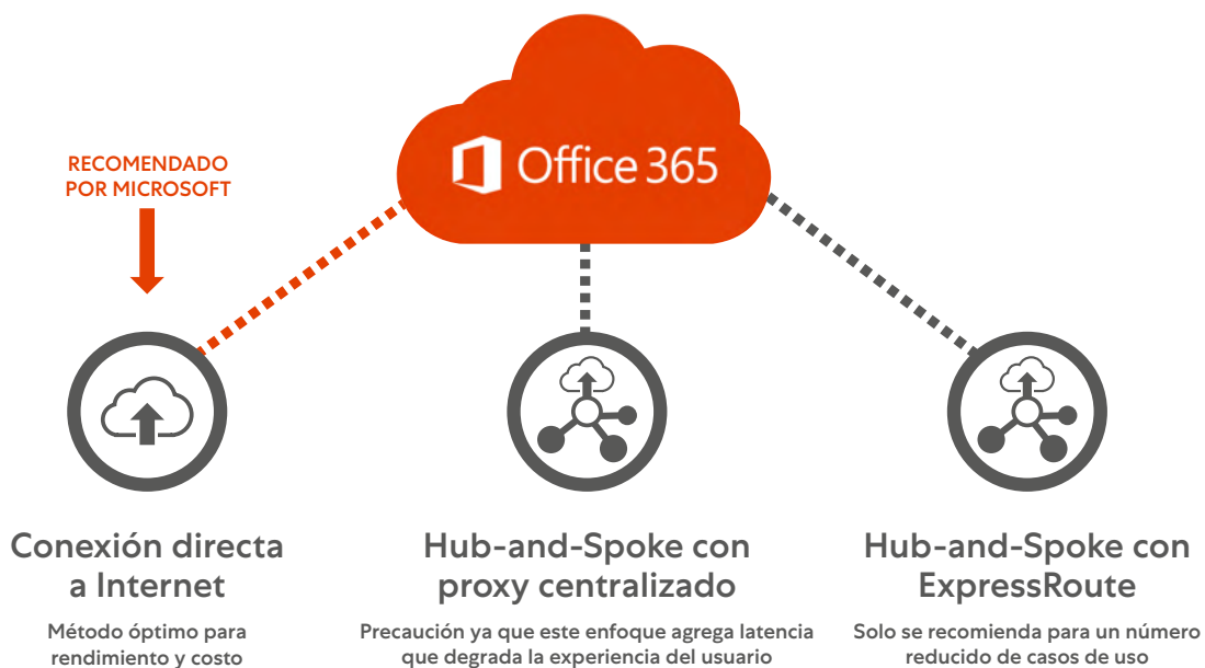
Figura 15: Microsoft recomienda una conexión directa a Internet como el método óptimo para el rendimiento y el costo, alineándose con los principios de SSE (fuente: microsoft.com).
